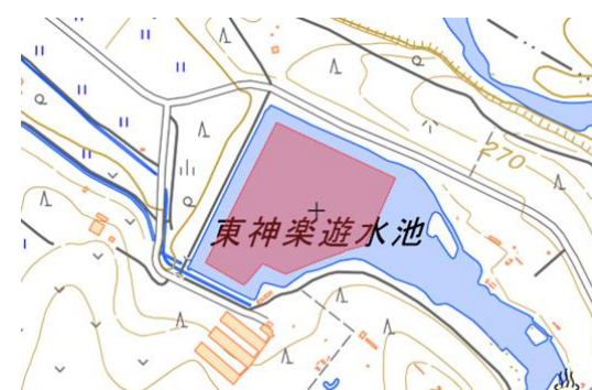
フロート式の設置イメージ ※設置可能面積は図の赤網の部分のうち40%とした
