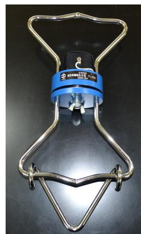
6. 小型強力電磁石 (1個)・・・単1電池1個で、大人1人の重さ60Kg を保持できる強力電磁石です。両サイドに取手があるので引き合ったり、付属の V 字フックを使用してバケツを吊り上げることができます。
