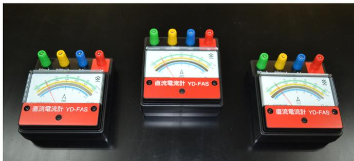
4. 直流電流計 (3台)・・・実験台のどの場所からも目盛りの確認でき、端子と目盛りの色を対応させた電流計です。端子の取り付け面を赤 (+)、黒 (-) に色分けされており、極性間違いを防ぎます。
