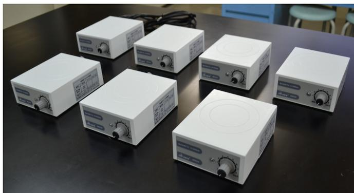
5. マグネチックスターラー (7台)・・・磁力を利用して攪拌子を回転させ、液体を攪拌する装置です。速度が一定に維持できます。
